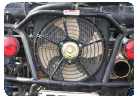
Радиатор охлаждения надежно защищен и расположен в задней части багги
