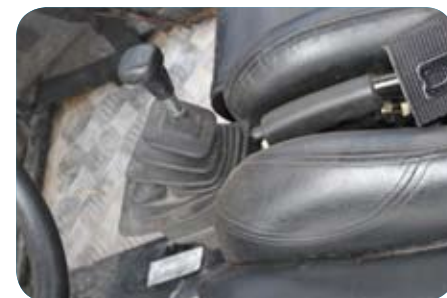
Селектор переключения передач работает в алгоритме, аналогичном ATV с режимами H-L-N-R
